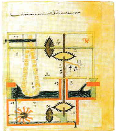
Figura A.1.2. Una dintre realizările importante ale lui Al-Jazari, o pompă automată acționată de forța apei
